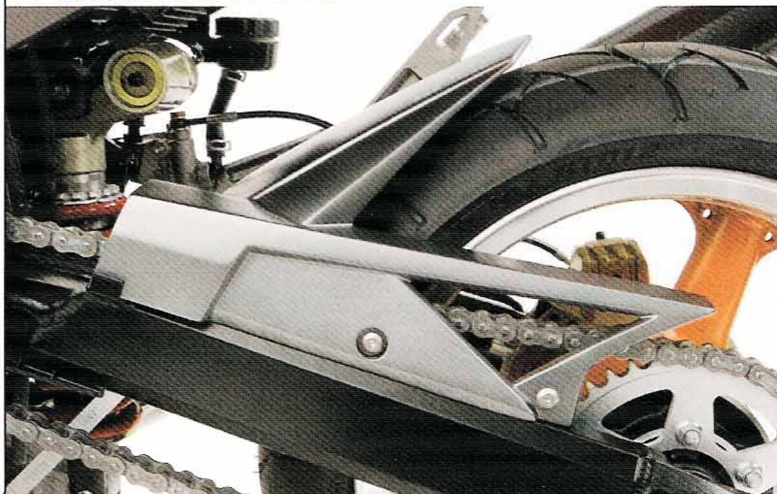
Nimm 2: Der Kettenschutz ist separat und als Variante im Verbund mit der Hinterradabdeckung erhältlich (unten)
